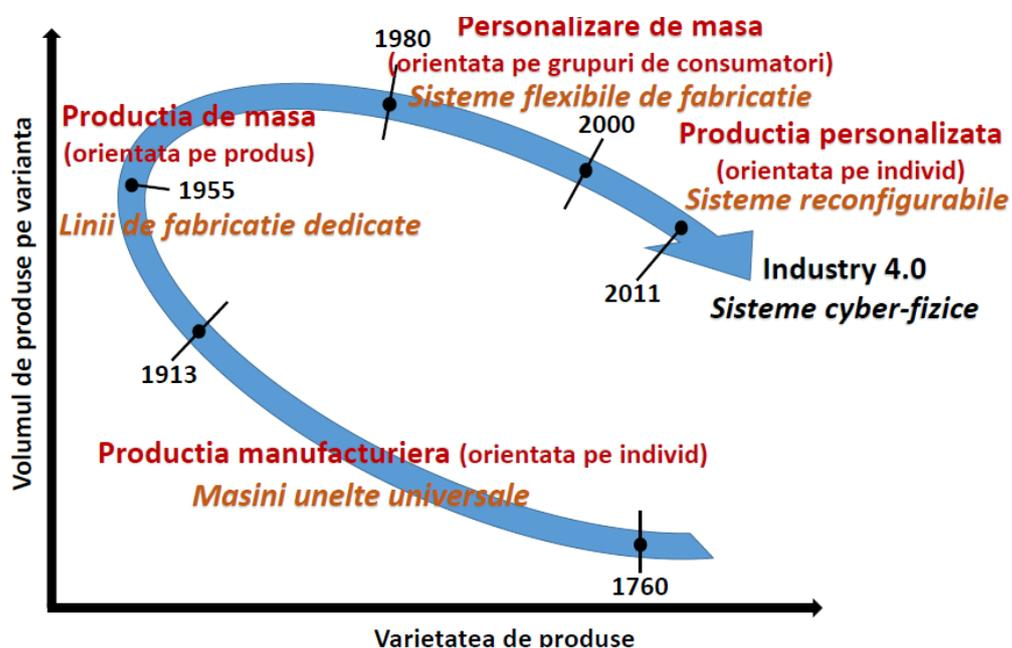
Abbildung. 2. Die zyklische Entwicklung der Fertigung von der ersten bis zur vierten industriellen Revolution.
